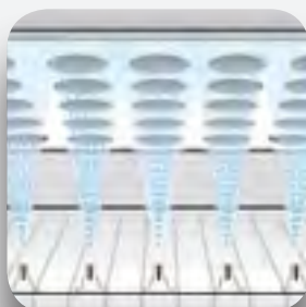
Sistema de rociado por aspersores.
