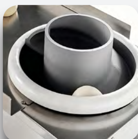
Cilindro y espiral recubiertos de teflón.
