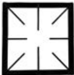
Parrilla estándar MOB-1H / PAV-1H (Hueco: 560 x 520) Standard rectangular burner grid (MOB-1P/PAV-1P (560 x 520 mm)
